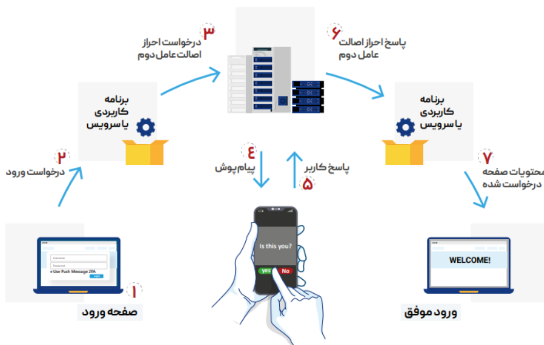
شکل ۵. سناریو نمونه استفاده از سامان-MFA برای احراز اصالت چندعاملی مبتنی بر روش پیام پوش
